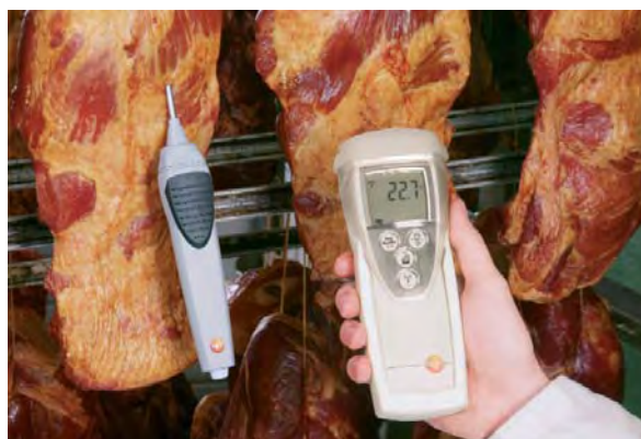
Zjišťování teploty jádra během procesu uzení, bezdrátový přenos naměřených dat rádiovým signálem
