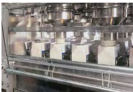
Přetlak v plnicí napomáhá dodržení hygienických podmínek při potravinářské a farmaceutické výrobě.
