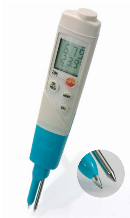
pH2 - vpichovací sonda do polotuhých látek
