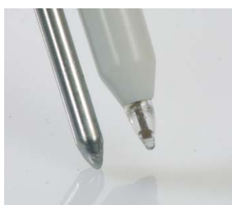
Špička pH elektrody je chráněna plastem, aby se zvýšila její odolnost proti zlomení
