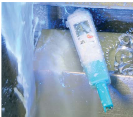
Ochranné pouzdro topsafe chrání přístroj i v těžkých podmínkách průmyslového provozu
