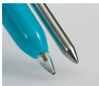
pH2- vpichovací sonda do polotuhých materiálů
