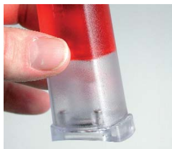
roztok chloridu draselného ve formě gelu je odolný proti vypadnutí
