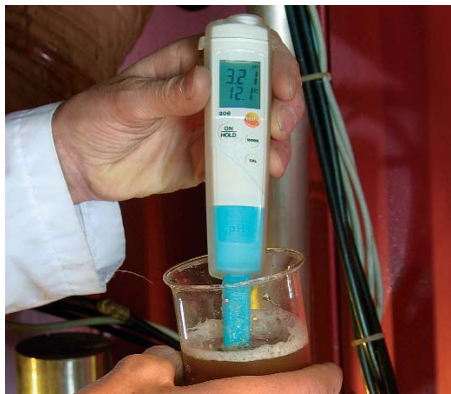
pH metr testo 206-pH1 je ideální pro měření v kapalinách
