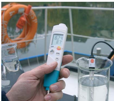
Automatická teplotní kompenzace u sond vybavených teplotním senzorem
