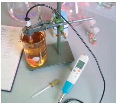
testo 206-pH3 umožňuje připojení externích pH elektrod
