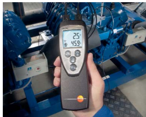
Současné měření přehřátí a podchlazení na chladicím zařízení pomocí přístroje testo 922
