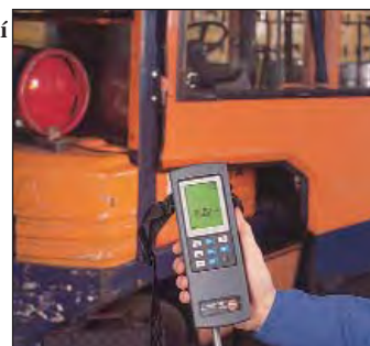
Kontrola spalovacího motoru analyzátořem COhigh
